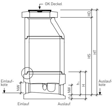
**Falz System Gleitdichtung**
