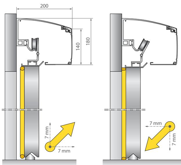
Gilgen Automattür SLX-D hermetic mit abtropfender Verschalung. Laufwagenstellung im Normalbetrieb.
