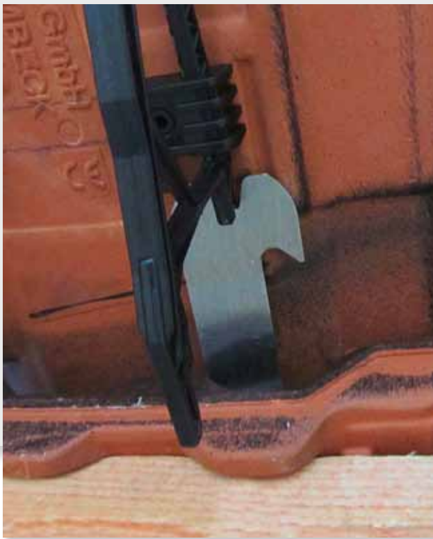
DACHSTICK® nach oben schieben...
