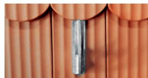
Der SH AGZ Sicherheitshaken ist nach EN 517 Typ B geprüft: Der SH AGZ Sicherheitshaken kann in allen Belastungsrichtungen, d. h. auf dem Steildach nicht nur zur Traufe, sondern auch zum Ortgang und zum First, bzw. über den First hinweg, verwendet werden. So ist es möglich, sich vom Haken aus in alle Richtungen auf dem Dach frei zu bewegen oder auch den First zu überqueren.
