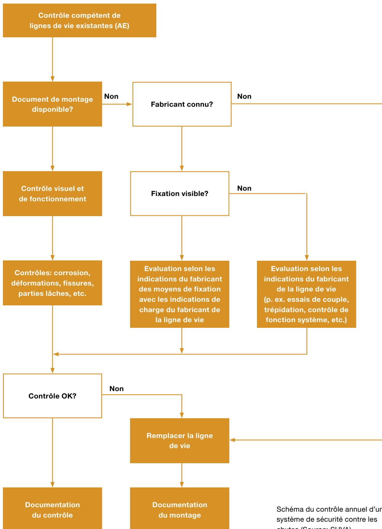
Schéma du contrôle annuel d'un système de sécurité contre les chutes (Source: SUVA).
