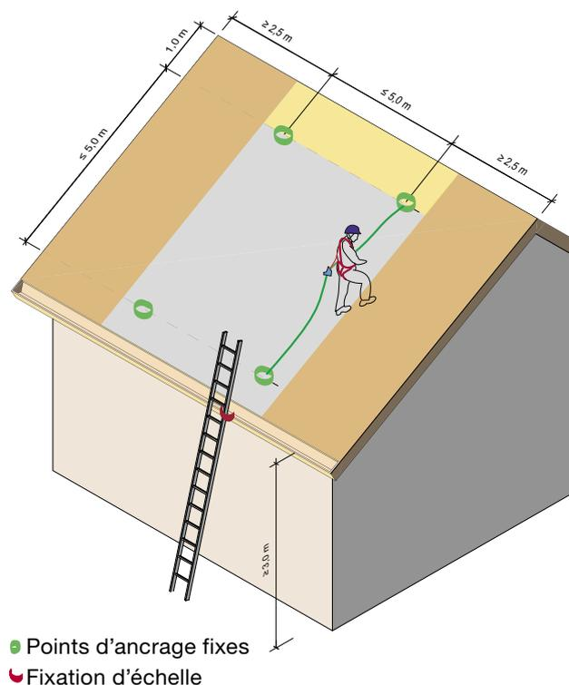
Zones de danger avec inclinaison de toit < 40° (la représentation est une recommandation); le premier point d'ancrage doit être accessible depuis une échelle. Zone de danger particulier = surface rouge.
