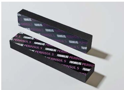
FOAMGLAS® PERINSUL S è un prodotto speciale ad altissima resistenza alla compressione inteso ad evitare i ponti termici. L'elemento è spalmato sul lato superiore e inferiore con bitume e rivestito con uno strato in fibra di vetro. Lato superiore è di colore viola.
