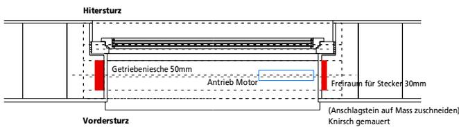
Variante Einschalen-Mauerwerk mit Wärmedämmstein.
