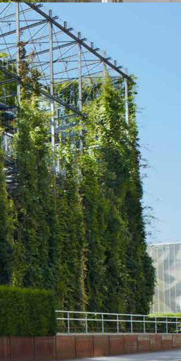
■ Webnet von Jakob® Rope Systems lässt sich als Fläche oder dreidimensionale Form spannen. Dem Einsatz dieser transparenten Netzstruktur aus Inox-Seilen sind keine Grenzen gesetzt.
