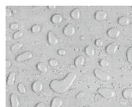
**faceal Technologie:** Saugende mineralische Untergründe werden modifiziert – Fassaden und Böden werden dadurch öl-, fett und wasserabweisend ausgestattet.
