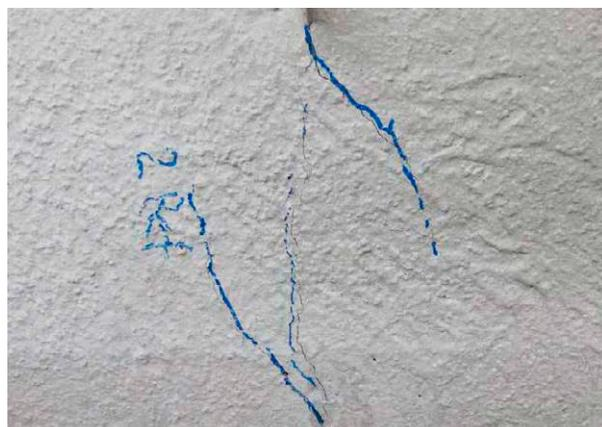
Les essais révèlent des angles d'inclinaison de champ de compression allant jusqu'à 70° ainsi qu'un comportement ductile jusqu'à la rupture.
