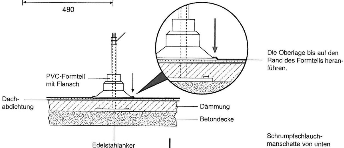
Schrumpfschlauchmanschette von unten nach oben erwärmen.
