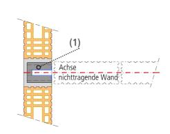
1 WEBEG-W Beton-Element mit Stahleinbauhülse (1) in der Achse der nichttragenden Wand mit Zementmörtel CEM 300 einmauern. Die Anzahl und Position der WEBEG-W sowie eine allfällige Mauerwerksbewehrung wird durch den Bau-Ingenieur festgelegt.
