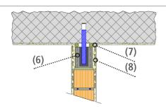
**3** Das Beton-Element des WEBEG-D (6) mit Mörtel CEM 300 vollfugig einmauern. Es wird empfohlen im Bereich der WEBEG-D eine Putzbewehrung (8) in den Grundputz einzubetten. Die Fugentrennung zwischen Wand- und Deckenputz ist nach Norm auszuführen.
