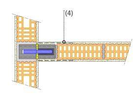
**3** Erstellen der nichttragenden Wand auf ISONOVA Akustik-Trennlager. Beton-Element des WEBEG-W mit Mörtel CEM 300 in nichttragender Wand einmauern. Es wird empfohlen, im Bereich der WEBEG-W eine Putzbewehrung (4) in den Grundputz einzubetten. Die Fugentrennung zwischen dem Putz der beiden Wände ist nach Norm auszuführen.
