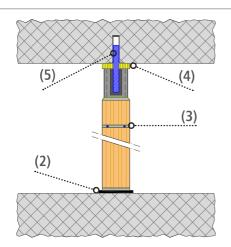
**2** Decke ausschalen. Nichttragendes Mauerwerk auf ISONOVA Akustik-Trennlager (2) erstellen. Einbau einer Mauerwerksbewehrung (3) nach Angabe Bau-Ingenieur. WEBEG-D mit Dorn (5) in die Stahleinbauhülse (1) einschieben.
