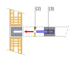
2 Nach dem Aushärten des Mörtels ISONOVA-LS-10 Akustik-Trennlager oder ISOPE-10 Weichschaumstoff als Trennschicht auf das Mauerwerk aufkleben (2). Danach WEBEG-D mit Dorn (3) durch die exakt ausgeschnittene Öffnung der Trennschicht bis Anschlag in die Stahlhülse einschieben.
