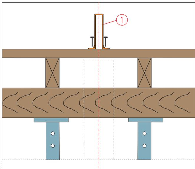
Les murs non porteurs sont mesurés sur le coffrage avant armature. Les douilles en matière synthétique de l'élément **WEBEG-D** fourni (1) sont clouées sur le coffrage exactement dans l'axe du mur, et avec l'entraxe défini par l'ingénieur de construction.
