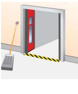
Ein Handsender erlaubt die Torbedienung aus einem Fahrzeug heraus oder von einem beliebigen Standort im Umkreis von 50-100 m um Empfänger und Antenne am Tor. Zum Schließen kann das Tor mit einer Lichtschranke ausgerüstet werden. Empfänger in Steuerung installiert, Antenne an der Wand neben dem Tor.
