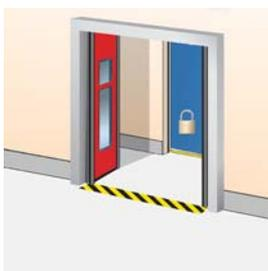
Entwickelt für Klimasteuerung oder Sicherheit. Wenn Tor A geöffnet ist, kann Tor B nicht geöffnet werden. Wenn Tor B geöffnet ist, kann Tor A nicht geöffnet werden. Ein so gesperrtes Tor kann einen Öffnungsbefehl speichern, sofern über einen Mikroschalter ausgewählt. Leiterplatte installiert in Steuerung.
