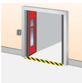
Wenn die Hauptsteuerung weit von der Toröffnung entfernt montiert werden muss, wird eine extra Steuerung außen oder innen in der Nähe des Tores montiert. Installation an der Innen- oder Außenwand neben dem Tor.
