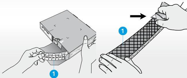
Detail A - Entnahme und Ablängen des Manschettenbandes
