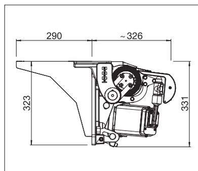
Montage sous dalle avec équerre de fixation
