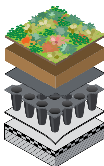
Aufbau Nophadrain Gründachsystem Extensiv mit ND 5+1
