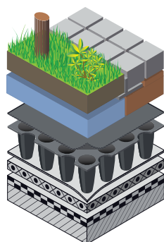
Aufbau Nophadrain Gründachsystem Intensiv mit ND 5+1
