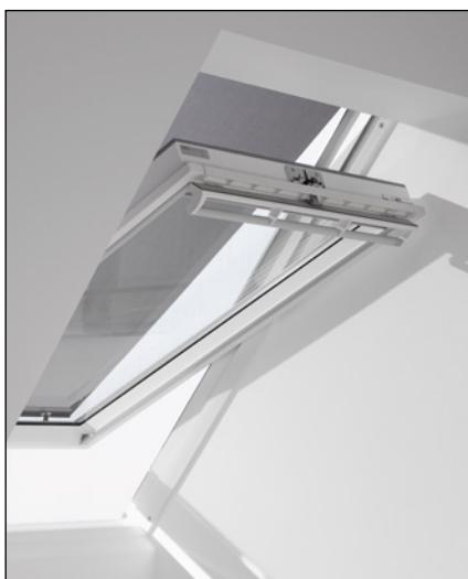
Manuell bedienbare Markisette ohne seitlichen Führungen, wird von Hand auf-/ausgezogen und an Haltekrallen eingehängt. Einbauhöhe max. 2,00 m (Oberkante Dachfenster). MHL kann ausschliesslich auf manuelle Fenster montiert werden.
