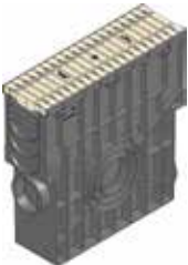
Einlaufkasten mit Kunststoff-Eimer und FIBRETEC Design Stegrost in der Farbe Sand, SW 9 mm, Klasse C 250, arretiert
