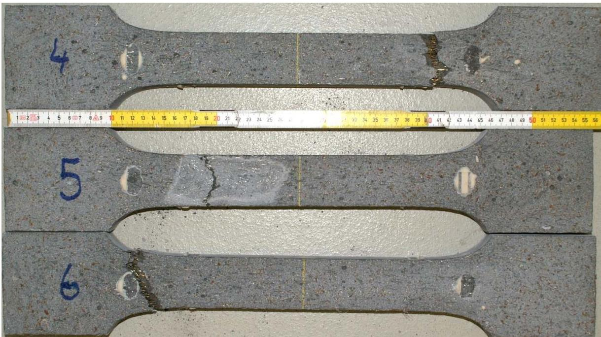
Abb. A2: Prüfkörper 4 – 6 nach der Prüfung. PK4 und PK6 = Riss ausserhalb  $l_{mes,1}$ .
