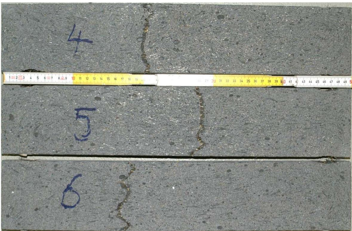
Abb. A4: Prüfkörper 4 – 6 nach der Biegezugprüfung.
