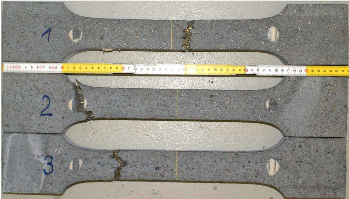
Abb. A1: Prüfkörper 1 – 3 nach der Prüfung. PK2 = Riss ausserhalb  $l_{mes,1}$ .
