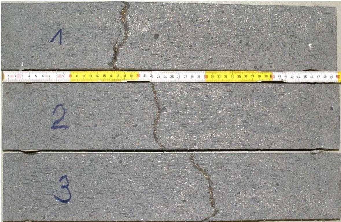
Abb. A3: Prüfkörper 1 – 3 nach der Biegezugprüfung.
