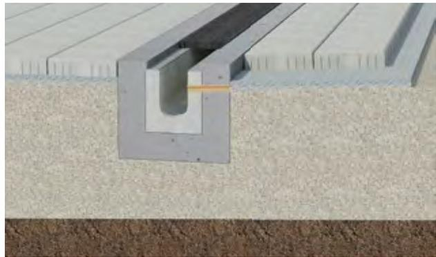
Darstellung 16: Entwässerungsrinne mit integriertem Betonriegel und Entwässerung der Bettungsschicht
