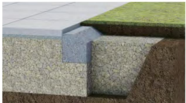
Darstellung 43: Anbetonieren der Gehwegplatten
