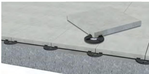
Darstellung 37: Platten verlegt auf starrer Betonkonstruktion mit Auflagerringen
