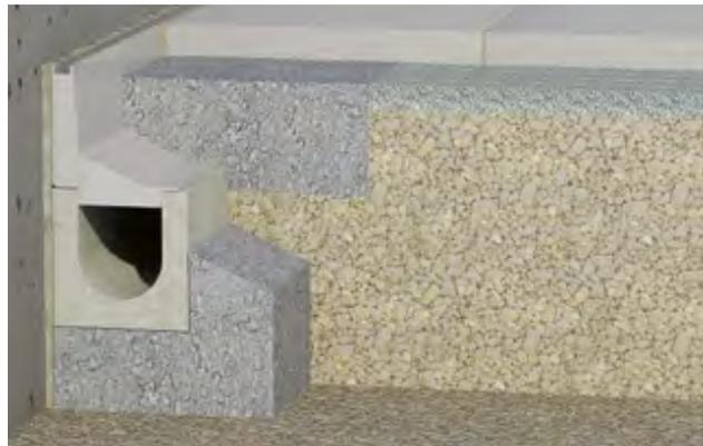
Darstellung 46: Entwässerungsrinne mit exzentrischem Schlitzaufsatz für die Entwässerung entlang einer Wand oder Treppe
