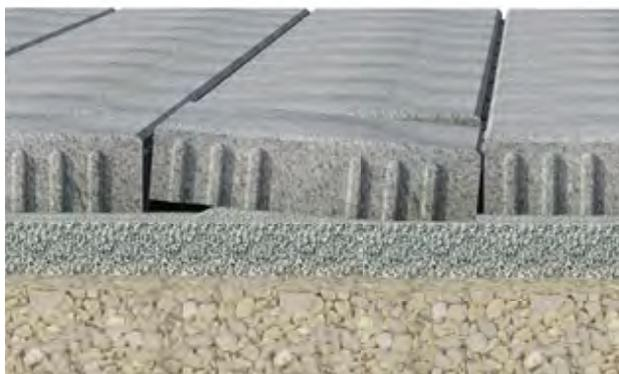
Darstellung 24: Schubverhalten mit starker Deformation bei geringer Steinstärke
