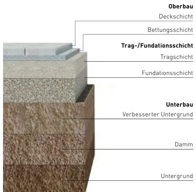
Darstellung 49: Schematisch detaillierter Aufbau
