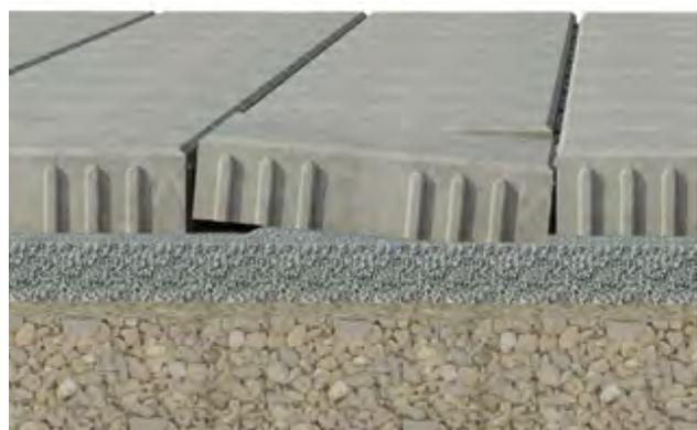
Darstellung 6: Schubverhalten mit starker Deformation bei geringer Steinstärke
