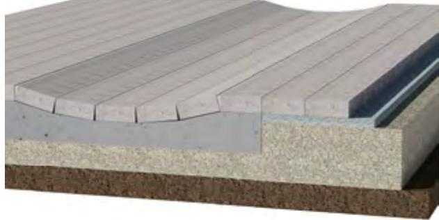
Darstellung 17: Entwässerungsrinne, ausgeführt mit Pflastersteinen
