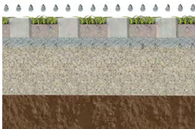
Darstellung 56: Wasserabtransport durch die aufgeweiteten Fugen oder eingelassenen Kammern
