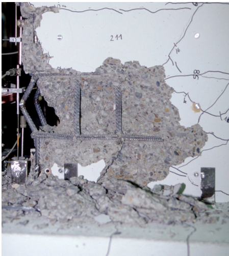
Bild 1: Ausknicken der Längsbewehrung zwischen Randbügeln im Abstand von 12 \varnothing_{sl} der Stahlbetontragwand WSH4 (links) und Vergleich der Horizontalkraft-Horizontalverschiebungs-Hysteresekurven der Stahlbetontragwand WSH4 mit der Stahlbetontragwand WSH3 mit Randbügeln im halben Abstand von 6 \varnothing_{sl} (grün hinterlegt, rechts) 2
