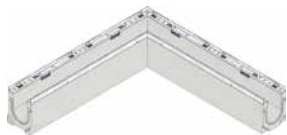
Gehrungsschnitt für NW 100 (zwei Schnitte pro Verbindung notwendig)
