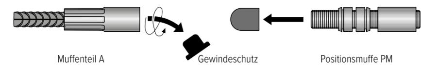
3 Gewindestange der Modix® PM von Hand bis zum Anschlag in Muffenteil A eindrehen.
