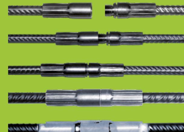
MODIX® dient der Verbindung von Betonstahl. MODIX® Muffen werden auf den Muffenstab und den Anschlussstab aufgepresst. Durch die Verschraubung der MODIX® Schraubmuffen entsteht ein vollwertiger Druck- und Zugkräfte übertragender Anschluss.
