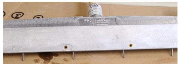
Nach der Aushärtung wird **CONIPUR 3380 FL** mit einer **Zahnrakel** appliziert.
