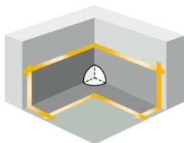
Façonner la découpe 1 en forme d'entonnoir / l'insérer immédiatement dans la première couche encore mouillée de BauderLIQUITEC PU sans plis et sans cavités avec une légère pression.
