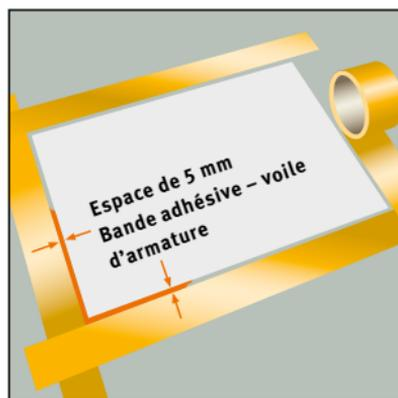
Lors de la coupe du voile d'armature, assurez-vous qu'il reste environ 5 mm d'espace entre le voile et la bande adhésive de masquage. Avec un espace plus grand que 5 mm, il y a un risque que la résine se rétracte ultérieurement. Dans le cas d'un espace inférieur ou si
