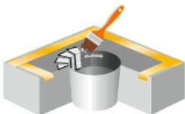
Insérer les découpes 1 sur la première couche encore mouillée de résine BauderLIQUITEC PU sans plis et sans cavités et appuyer légèrement.
