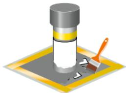
Le chevauchement du voile d'armature sur la découpe d'angle doit être imprégné entre les couches avec de la résine PU de BauderLIQUITEC, de sorte qu'aucune couche de voile ne se superpose sans couche intermédiaire de résine liquide.
