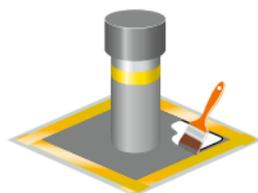
Appliquer immédiatement la couche de finition en mode «mouillé sur mouillé» sur le voile d'armature (environ 1/3 de la consommation spécifiée restante).
