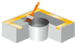
Appliquer la première couche de résine synthétique liquide BauderLIQUITEC PU généreusement et uniformément (environ 2/3 de la consommation spécifiée). S'assurer qu'aucune résine liquide ne coule dans la naissance.
