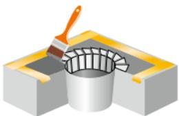
Insérer les bandes avec un recouvrement d'environ 1 cm, le recouvrement doit être imprégné de résine BauderLIQUITEC PU entre les bandelettes de manière à ce qu'aucune couche de voile ne soit insérée sans résine.
