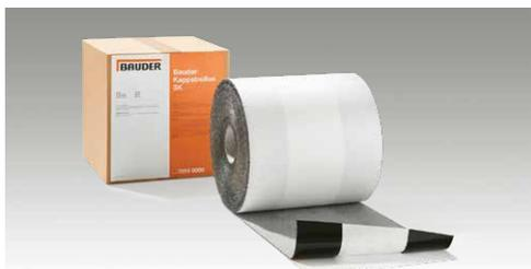
Bandes de recouvrement perméables à la vapeur autocollantes d'un côté, pour l'emballage des contres-lattes avec membrane BauderTOP ou éléments d'isolation thermiques PIR. Utilisables dans le secteur de sous-couverture pour contraintes extraordinaires, valeur-sd  $\leq 0,1$  m.
