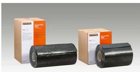
Bandes autocollantes sur une face en bitume spécial pour le collage des raccords pour toitures inclinées dans le secteur du faîte et divers détails, pour les éléments d'isolation thermique BauderPIR et les membranes BauderTOP, pour raccordement des zones de faitages, de noues ou des fenêtres de toiture.
