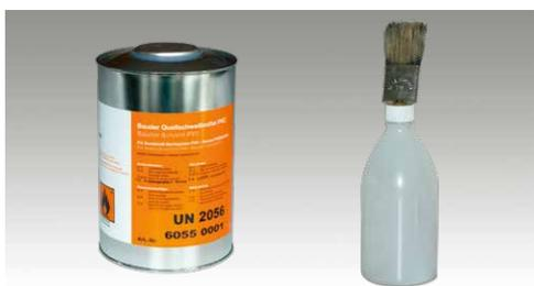
Solution liquide pour une soudure homogène pour membrane BauderTOP DIFUPLUS. Utilisation dès 5° C, température d'utilisation optimale 18 – 20° C. Bouteille à pinceau Bauder permettant une application aisée de la solution liquide de soudure.
