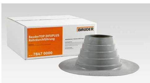
Manchettes façonnées pour l'étanchéité des passages entre Ø 80 – 120 mm de diamètre, pour toitures inclinées jusqu'à 25° de pente.
