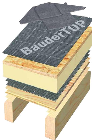
**Exemple de configuration BauderPIR MDE sous ardoise:** Plaques de plâtre et chevrons, lé pare-vapeur BauderVap, BauderPIR MDE, lé de sous-couverture BauderTOP TS 40 NSK
