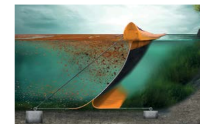
Barrière de retenue d'hydrocarbures sous l'eau
