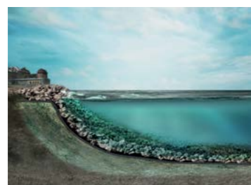
Couverture active du fond de cours d'eau et de plans d'eau
