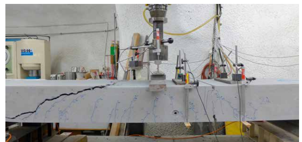
Les essais confirment la haute reprise des forces de cisaillement (85%).
