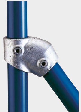
N° de commande 0520 3100 00 (26) Pièce en T Gamme de réglage 30° - 60°, pour main courante / Support central, Support terminal, Attelle de genou
