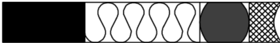
System 1: Vorkomprimiertes Dichtungsband, PU-Schaum, Hinterfüllschnur, Dichtungsmasse
