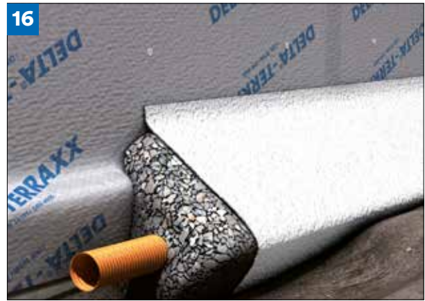
(Bild 16) Unten endet die Dränbahn DELTA®-TERRAXX dicht am Dränrohr. Die Dränleitung wird rundum mindestens 15 cm mit sickerfähigem Material umgeben (z. B. Kies 16/32). Ist der Kies nicht filterstabil, muss die Kiespackung in ein Geotextil (z. B. DELTA®-GEOTEXX FS 100) eingehüllt werden. Das Geotextil dabei nicht direkt um das Dränrohr wickeln, sondern immer um die komplette Kiespackung. Nur so ist eine dauerhafte Funktion gewährleistet. Die anschließende Verfüllung und Verdichtung erfolgt lagenweise. Der Füllboden soll dabei keine scharfkantigen Gesteinsbrocken mit mehr als 10 cm Ø enthalten.
