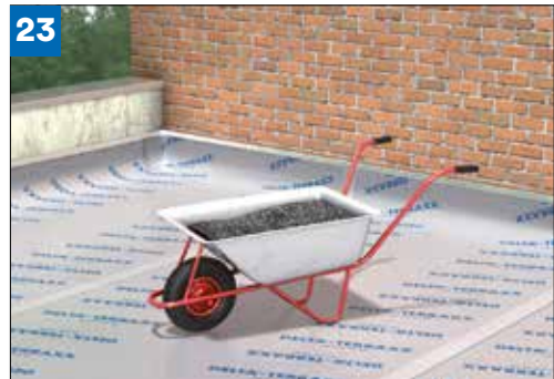
(Bild 23) Beim Einsatz auf erdüberschütteten Decken kann die verlegte Dränbahn zur Verfüllung direkt mit einer Schubkarre befahren werden. Bei vorauslaufender Schüttung von mind. 20 cm kann DELTA®-TERRAXX in der Bauphase vorsichtig mit einem Radlader befahren werden.
