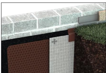
❷ Lorsqu'il est prévu de mettre en œuvre une membrane d'étanchéité\*, à chaud ou à froid (ex : DELTA®-THENE), celle-ci doit être remontée à 15 cm minimum au-dessus du niveau fini du sol, la fixation mécanique de la nappe à excroissances DELTA® étant réalisé juste au-dessus, sans percer l'étanchéité. Un solin métallique titulaire d'un Avis Technique sera ensuite utilisé pour la finition haute. La fixation à mi-hauteur et/ou l'assemblage des lés s'effectuera avec le Clou Adhésif DELTA®.
