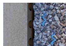
**Nappe de protection "simple"** : drainage aléatoire par le remblai selon sa perméabilité.
