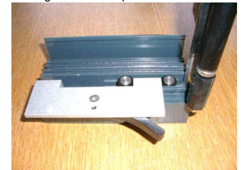
Montage der Fensterputz-Lehre
