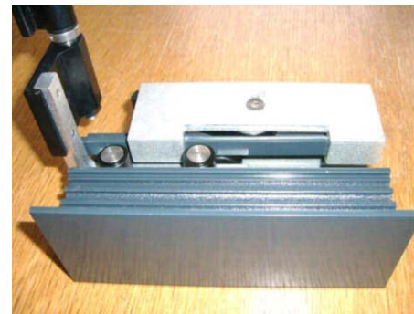
Montage la jauge de nettoyage des fenêtres
