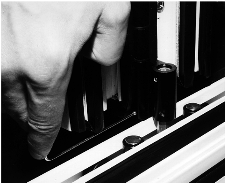
Abbildung 26: Sicherung des unteren Laufwagens
