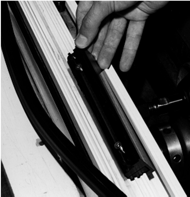
Figure 18 : Garniture dans le rail de roulement pour introduction des chapes de roulement
