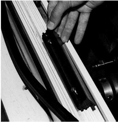
Figure 15: Garniture dans le rail de roulement pour introduction des chapes de roulement
