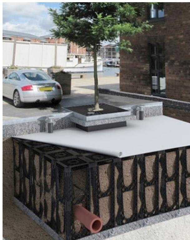
Das Greenleaf® Rootspace Wurzelkammersystem ist bis 26 Tonnen pro m<sup>2</sup> belastbar und somit auch für den Baumstandort im Strassenraum geeignet. Gegen seitlichen Bodendruck bieten die Seitenelemente zusätzliche Stabilität für die Baumstandorte. Die offene Struktur ermöglicht die problemlose Kombination mit Leitungen. Die Abdeckungen können später auch entfernt werden, um den Zugang zu den Leitungen sicherzustellen.
