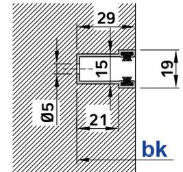
Führungsschiene zum Einlassen (EF)
