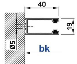
Verstärkte Führungsschiene (BR)<sup>(3)</sup>
