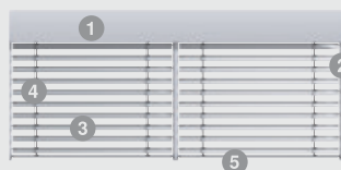
Brise-soleil orientable pour façades avec coulisses standards
