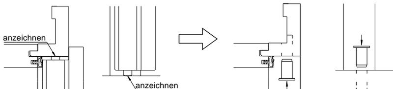
**Funktionselemente** Schlagleiste bei zweiflügeligen Türen: HSD-43 / RD-40-HSD
