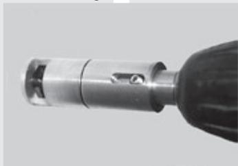
Perçage du trou concentrique Ø 4,1 mm dans le profilé porteur au à l'aide du guide de centrage (adapter l'avance de la mèche en conséquence)
