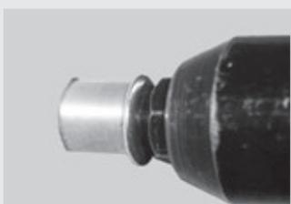
Pose du rivet avec douille pour point fixe longueur 16 mm
