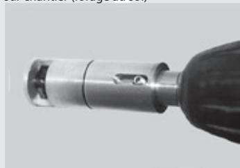
Perçage du trou concentrique Ø 4,1 mm dans le profilé porteur en alu à l'aide du guide de centrage 9541
