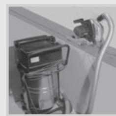
Scie circulaire manuelle avec rail de guidage et aspirateur
