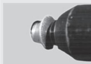
Pose du rivet avec douille pour point fixe longueur 6 mm
