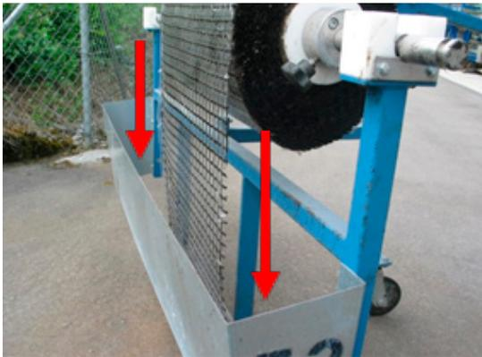
Die S&P Asphaltbewehrung muss innerhalb der Blechabdeckung verlaufen.
