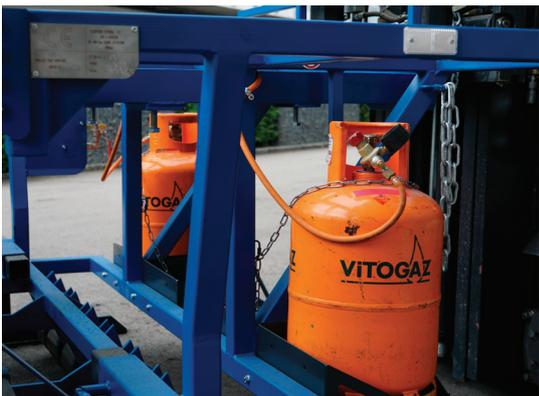
Insérer les bouteilles de gaz, connecter et fixer avec une chaîne.
