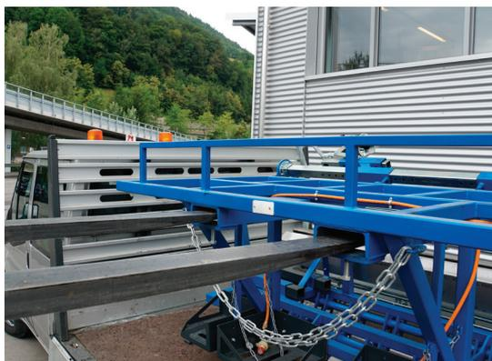
Insérer les fourches de la chargeuse à pneus dans les trous de montage et soulever légèrement.
