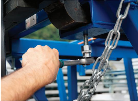
Tirer la chaîne de sécurité derrière les fourches et l'attacher à celles-ci.
